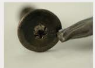
ねじが破損する前にビットが先に破損。このビット破損値を参考に最小破壊トルクを設定。
